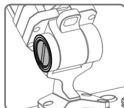
Воспользуйтесь монетой или отверткой (в комплекте), чтобы отрегулировать плотность затяжки по оси наклона.
