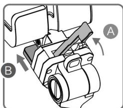
Убедитесь, что фиксатор на Части В открыт. Соедините Часть В с Частью А.
