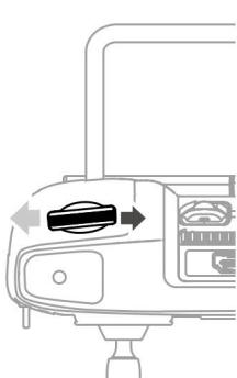
Левое колесико управляет наклоном стабилизатора. При повороте колесика вправо стабилизатор отклоняется вперед. При повороте колесика влево стабилизатор отклоняется назад. Если колесико не двигается, камера остается в текущем положении.
