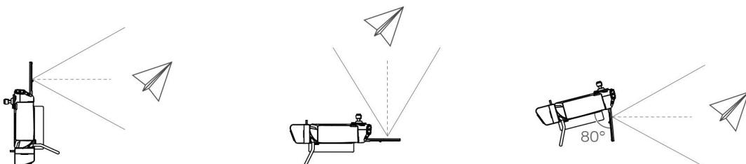
Убедитесь в том, что антенны направлены на дрон. Если угол между антеннами и задней панелью пульта составляет  $80^\circ$  или  $180^\circ$ , достигаются оптимальные характеристики соединения между пультом управления и дроном.
