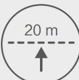
Если возврат домой (включая умный возврат домой, возврат домой при низком заряде аккумулятора или аварийный возврат домой после повторного подключения пульта дистанционного управления и дрона) срабатывает, когда дрон находится ниже 20 м, он автоматически поднимется на 20 м от текущей высоты. Вертикальную скорость можно регулировать с помощью джойстика тяги во время подъема с максимальной скоростью спуска 1 м/с и скоростью подъема 3 м/с.
