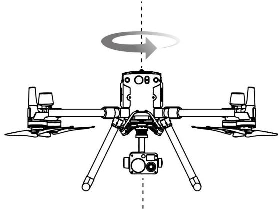
3. Удерживая дрон в вертикальном положении носом вниз, поверните его на 360 градусов вокруг центральной оси. Выполните повторную калибровку дрона, если индикаторы состояния дрона мигают красным.
