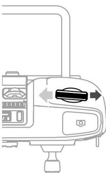
Правое колесико служит для управления поворотом стабилизатора. При повороте колесика вправо стабилизатор поворачивается по часовой стрелке. При повороте колесика влево стабилизатор поворачивается против часовой стрелки. Если колесико не двигается, камера остается в текущем положении.
