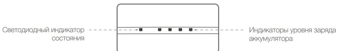
Индикаторы уровня заряда аккумулятора показывают оставшийся заряд аккумулятора пульта управления. Светодиодный индикатор состояния показывает статус сопряжения, а также предупреждения об использовании джойстиков, низком заряде аккумулятора и превышении допустимой температуры.
