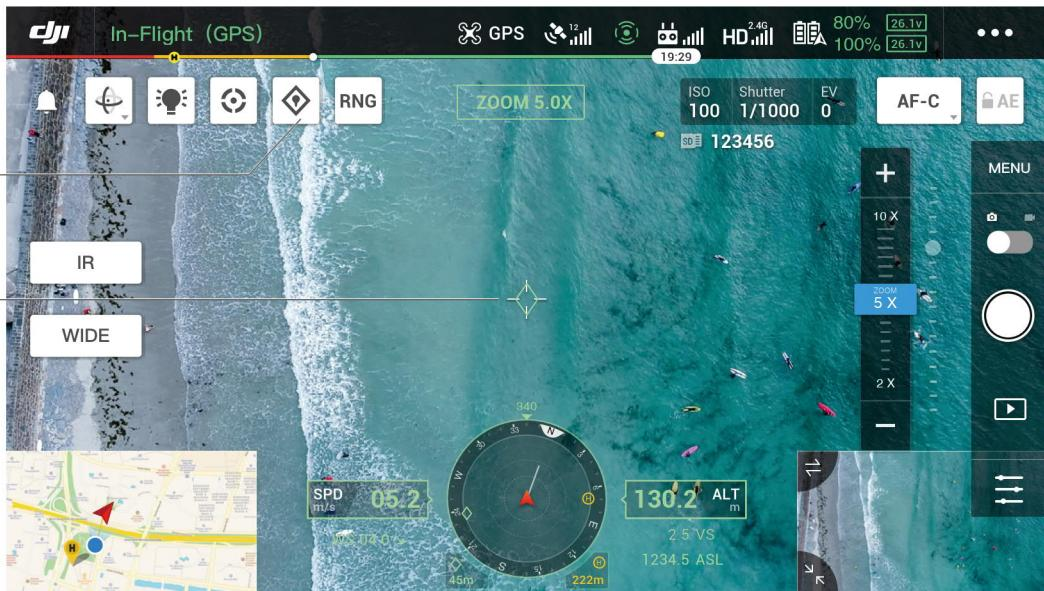
При использовании ПО дрона версии до v03.00.01.01 поддерживается отметка только одной точки. Данные каждой очередной отмеченной точки записываются поверх данных предыдущей.
