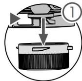
Нажмите кнопку отсоединения камеры, чтобы снять крышку.
