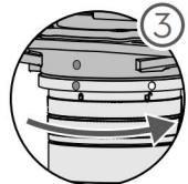
Поверните фиксатор стабилизатора в заблокированное положение.
