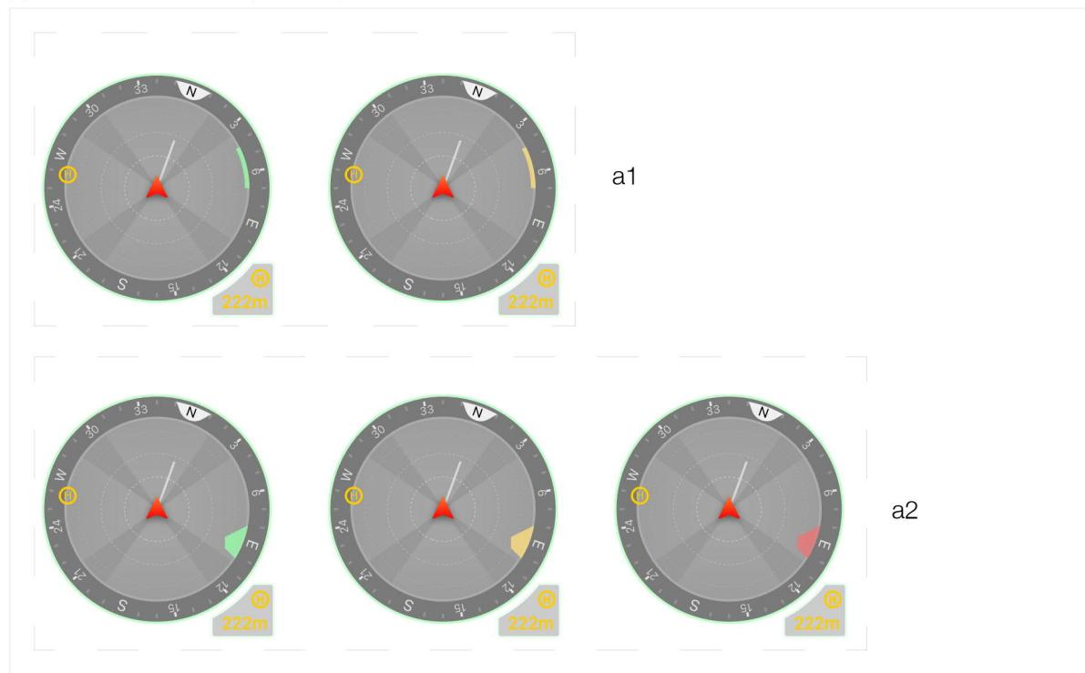
Области светлого цвета соответствуют зонам, контролируемым системой предотвращения столкновений, темные области — слепым зонам. Во время полета следует избегать попадания линии, обозначающей вектор скорости дрона, в слепые зоны системы предотвращения столкновений. В горизонтальной плоскости:
